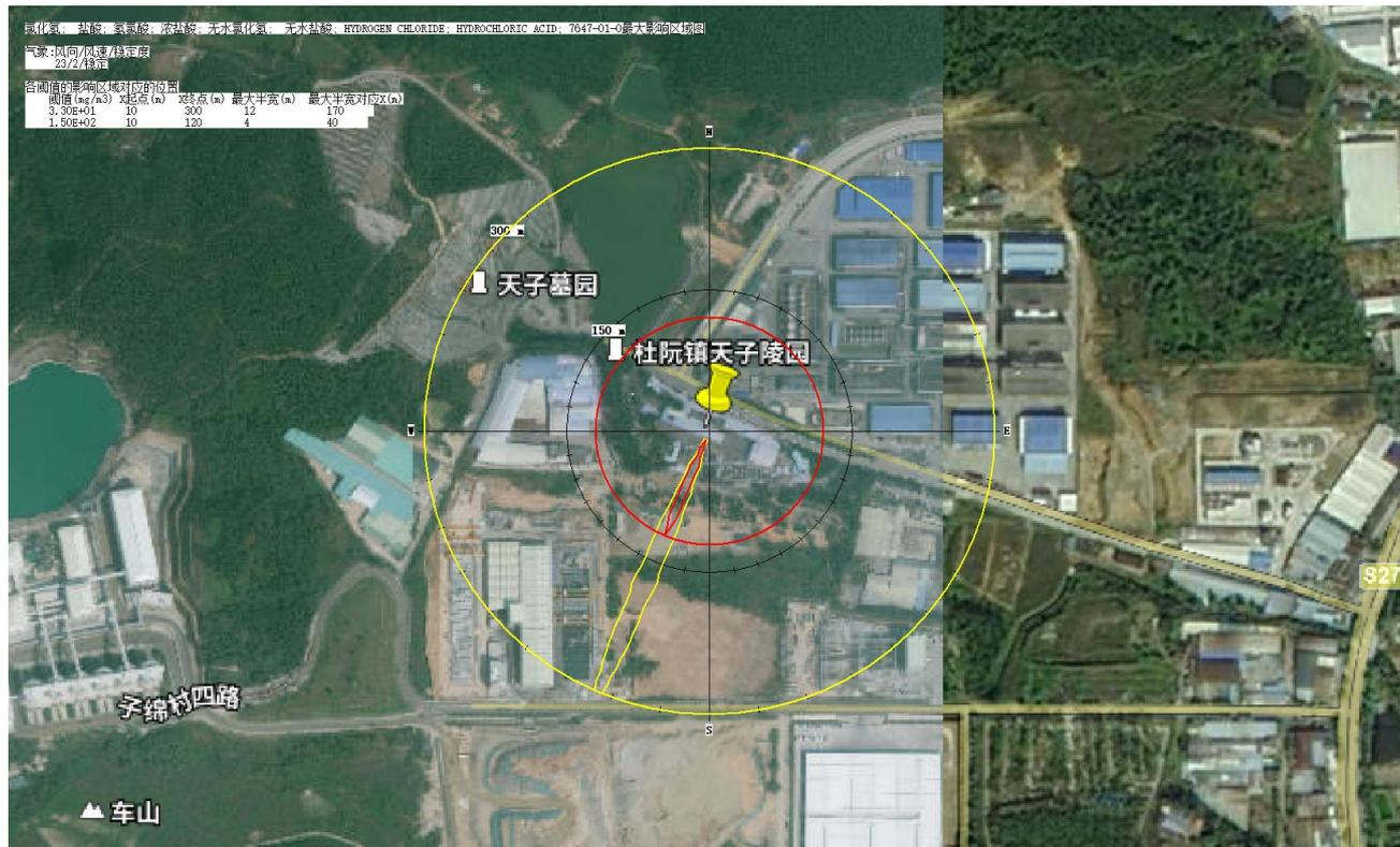
图 7.1-2 盐酸泄漏事故下风向不同距离处氯化氢最大浓度图和预测结果包络图
