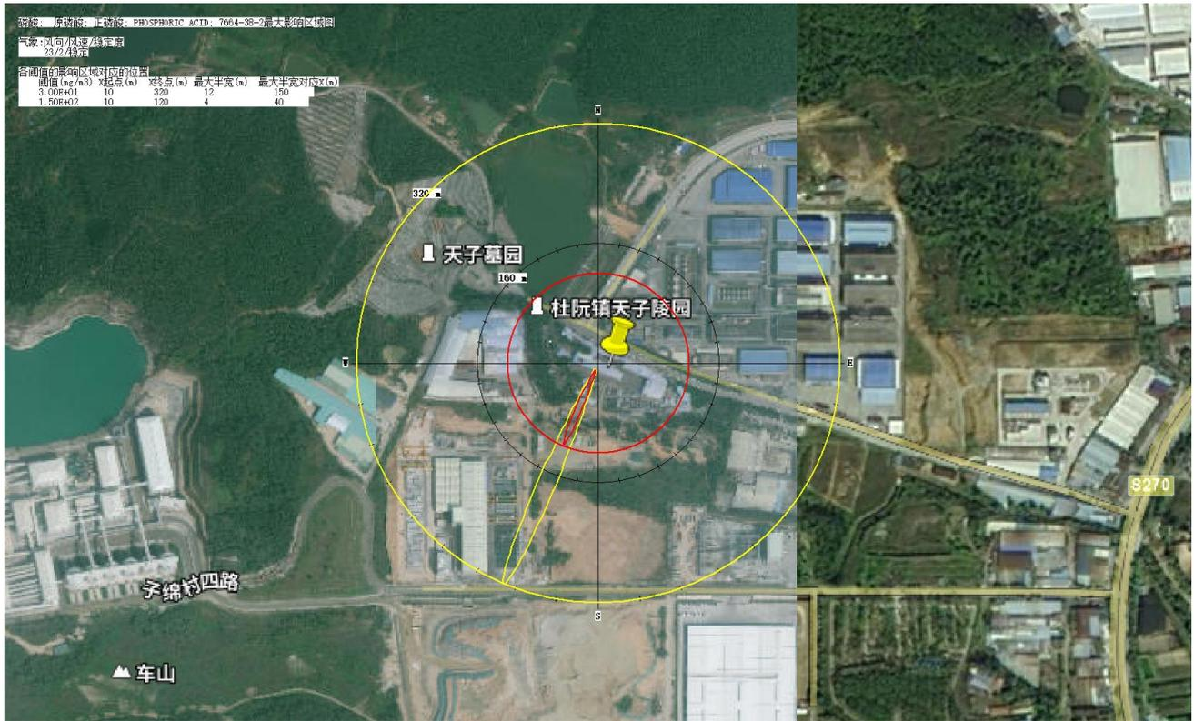
图 7.1-3 磷酸泄漏事故下风向不同距离处磷酸雾最大浓度图和预测结果包络图
