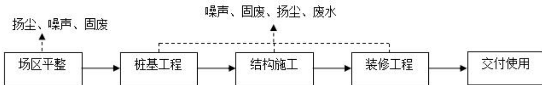
图 2-2 施工期生产工艺流程图
